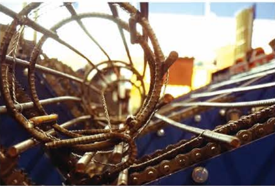
スパイラル筋でロールの形状を保持します
