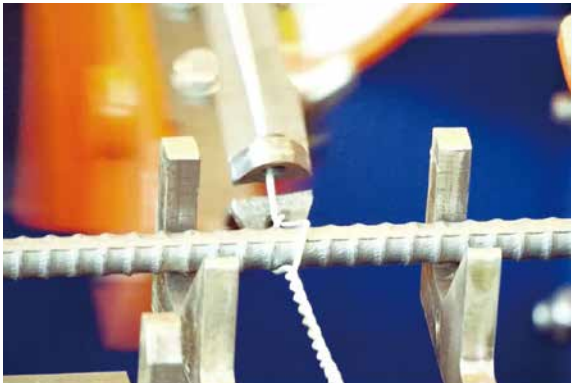
番線で鉄筋を編み込みます
